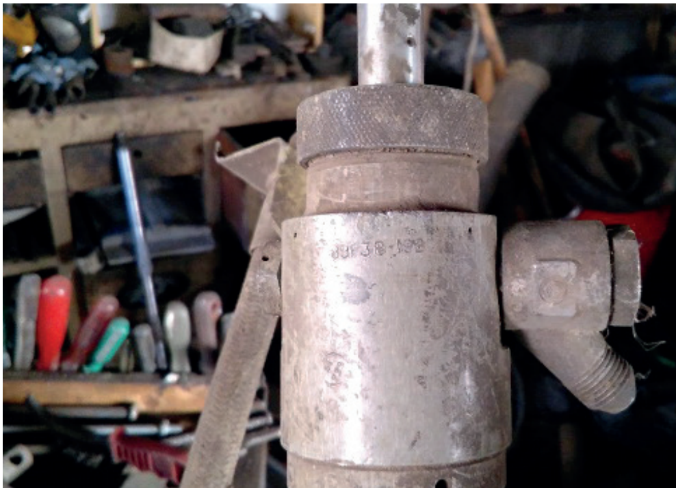
Il cilindro oleodinamico originale del P-47
