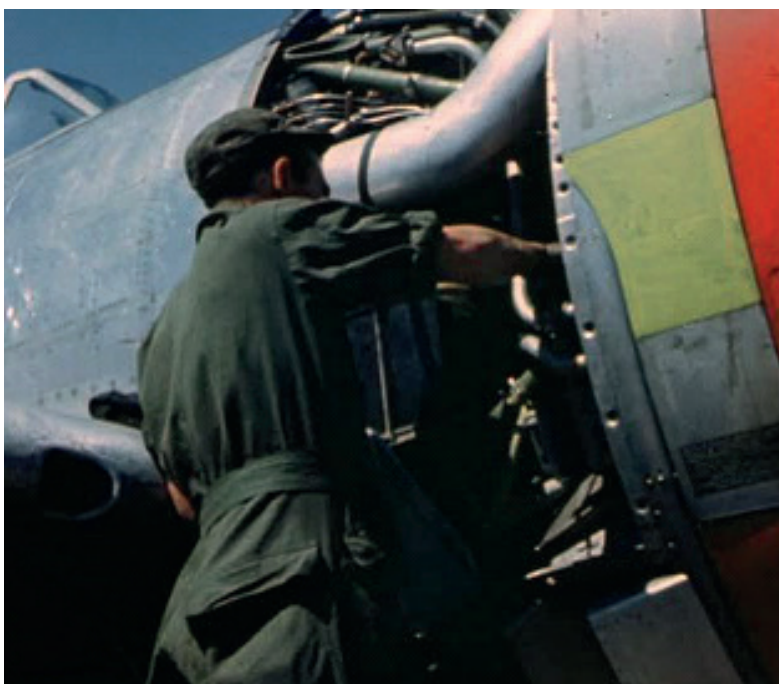
Condotta aria carburatore
