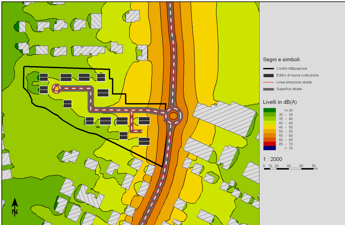
Figura 19: simulazione software (analisi del clima acustico post operam , mappatura periodo notturno)
