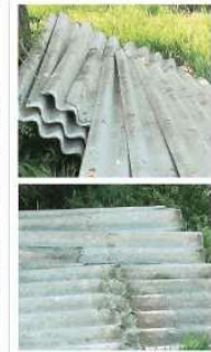
Lastre di amianto abbandonate
