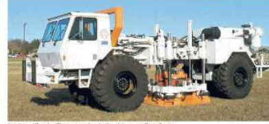
Un automezzo Vibroseis, utilizzato per scoprire nel sottosuolo la presenza di petrolio e gas
